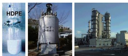
左から、ラボスケール反応器 (1L)、日本で最初の商用エチレン重合反応器 (8m<sup>3</sup>)、メタロセン触媒によるポリエチレンプラント (30万トン/年、千葉)
